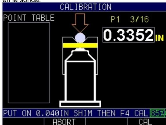
Nota: Si bien el medidor le pedirá que utilice valores específicos, puede medir los distintos puntos objetivo en cualquier orden.
