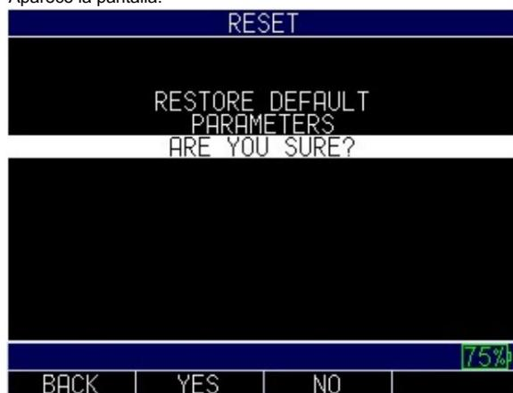
8. Presione la tecla F2 – Sí para restablecer todos los parámetros del medidor a la configuración predeterminada, o presione la tecla F3 – No para cancelar un restablecimiento de parámetros.
