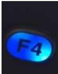
Para recargar la batería, simplemente conecte el cargador a una toma de CA (entre 100 y 240 V) y conecte el otro extremo al conector USB en la parte superior del medidor MTG-99. La tecla F4 se iluminará con un LED azul durante la carga y la luz se apagará cuando esté completamente cargada. Espere varias horas (hasta 10 horas) para que se cargue por completo.
