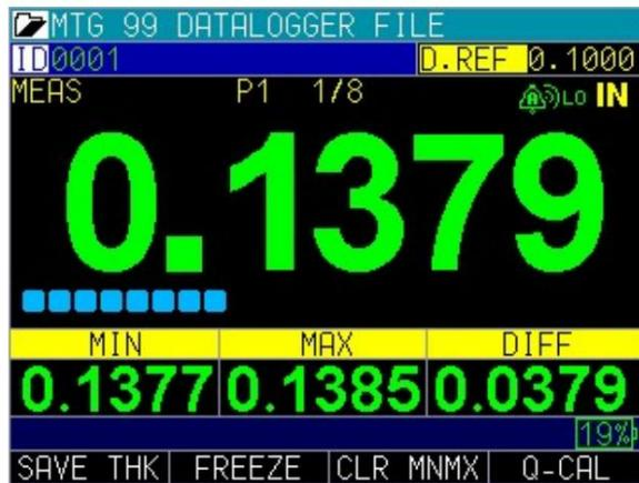
Para este ejemplo, supongamos que está utilizando una bola objetivo de 3/16 con un rango de 0,0001 a 0,360". Si activa la alarma alto-bajo, primero deberá ingresar el valor alto. Ingrese 0.300 pulgadas y presione la tecla MENÚ/OK.
