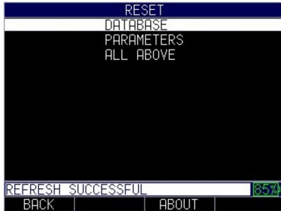
6. Utilice las teclas de flecha arriba y abajo para seleccionar Base de datos/Parámetro
