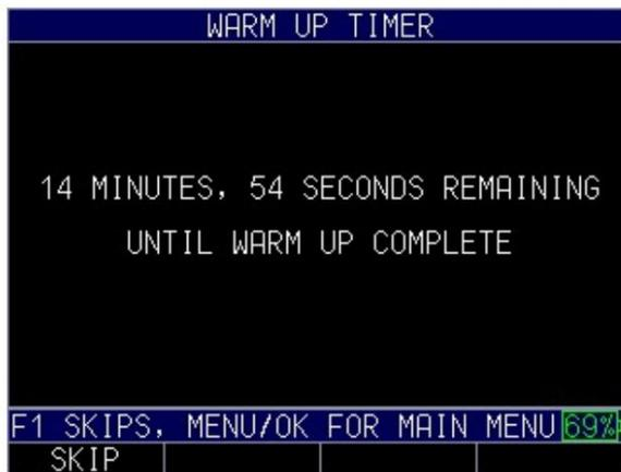
Nota: La temperatura juega un papel importante en la medición de espesores por efecto Hall. Es importante asegurarse de que la sonda y el medidor se calienten en el entorno en el que se utilizarán antes de calibrar y realizar mediciones.
