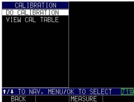
8. Presione la tecla MENÚ/OK para ir a la pantalla de calibración.
