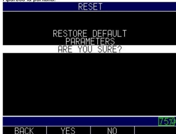
16. Presione la tecla F2 – Sí para restablecer todos los parámetros del medidor a la configuración predeterminada, o presione la tecla F3 – No para cancelar un restablecimiento de parámetros.
