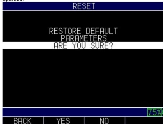
16. Presione la tecla F2 – Sí para restablecer la base de datos en el instrumento, o presione la tecla F3 – No para cancelar un reinicio de parámetro.
