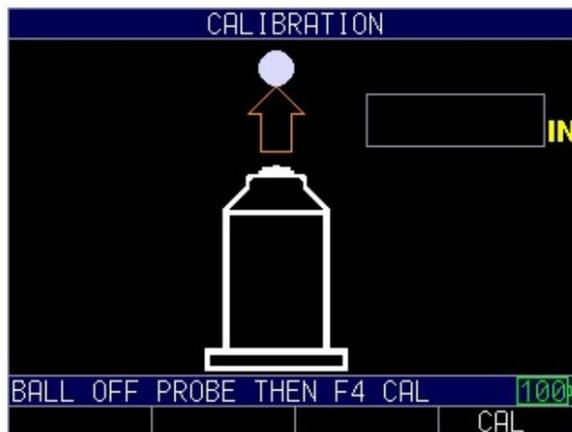
2. Coloque la bola objetivo en su bola respectiva en el dispositivo de calibración y coloque la accesorio firmemente en la sonda.
