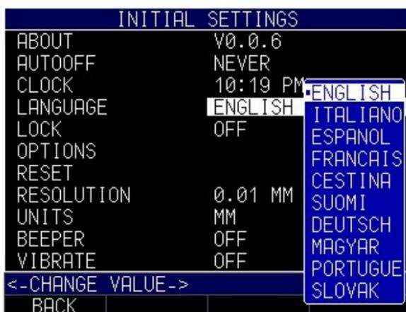
2. Utilice las teclas de flecha arriba y abajo para cambiar la configuración.
